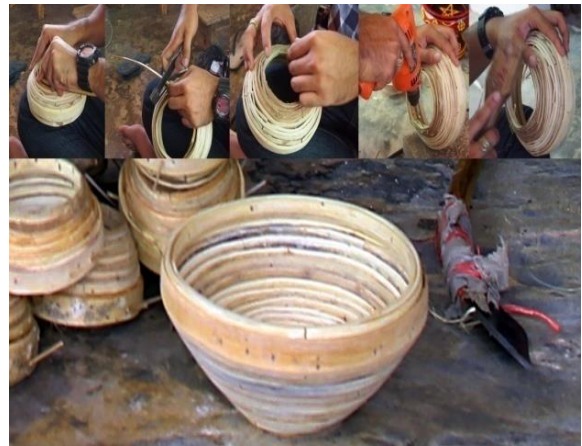
ภาพที่ 5 การขึ้นรูปส่วนบนของโตก ในขั้นตอนที่ 3) และ 4)
